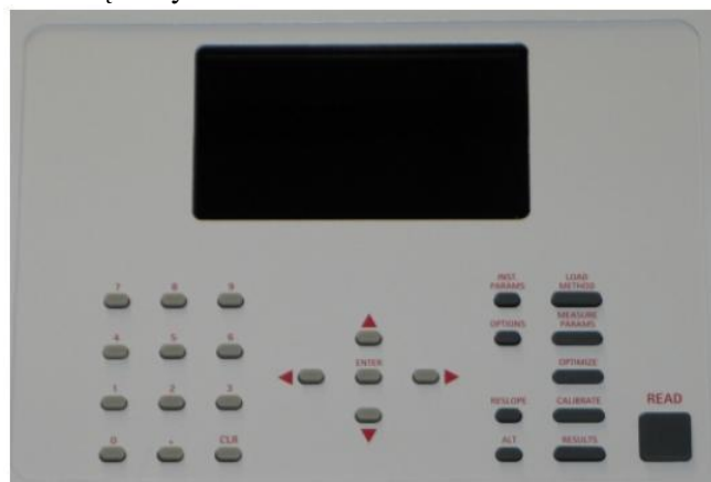
Rysunek 2. Wyświetlacz wraz z klawiaturą funkcyjną (po prawej stronie) i numeryczną (po lewej)
