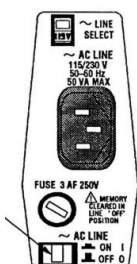
Rys. 6. Wyłącznik zasilania integratora HP3396 znajdujący się na ściance tylnej.
