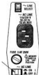
Rys. 7 Wyłącznik zasilania integratora HP3396 znajdujący się na ścianie tylnej.
